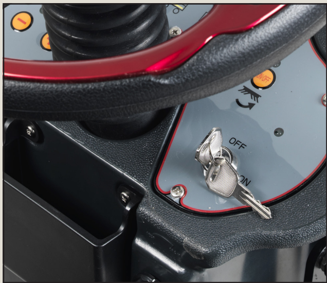
Wyłączyć maszynę używając klucza
