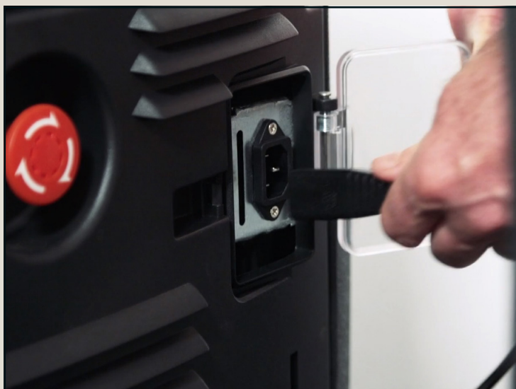
Podłączyć kabel ładowarki akumulatora do gniazda sieciowego
