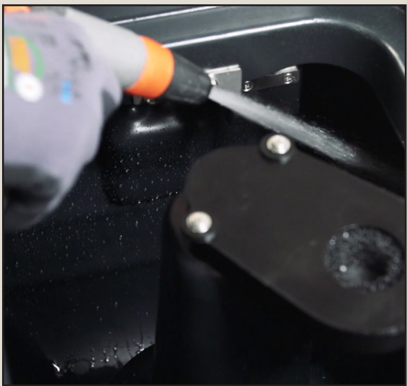
Opróżnić i umyć zbiornik na zanieczyszczenia oraz system płukawkowy
