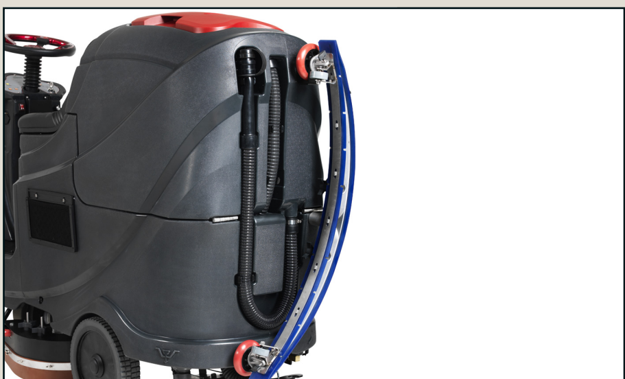
Zawiesić ssawę na maszynie i pozostawić do wyschnięcia
