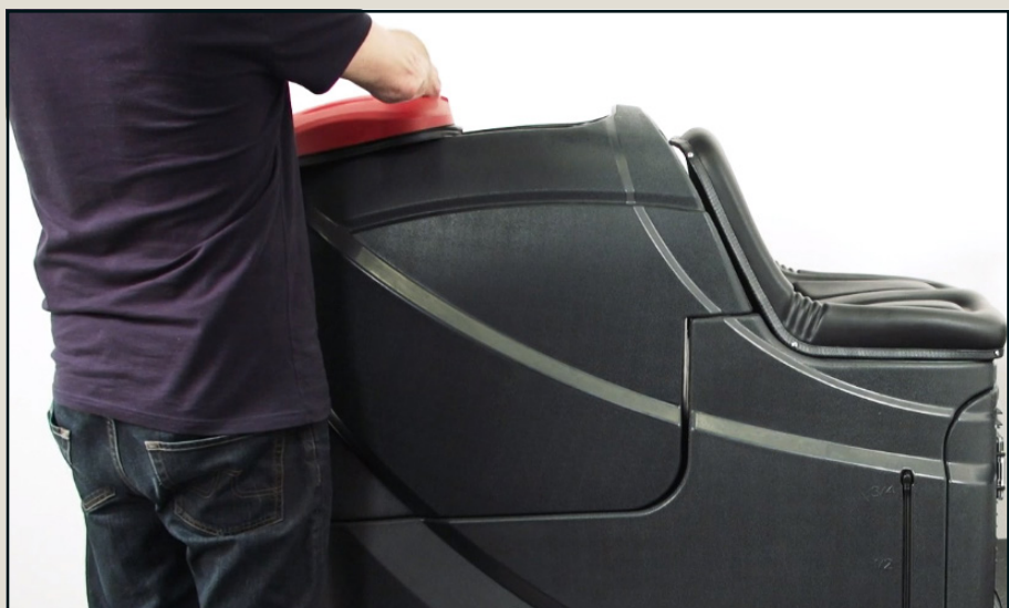
Zaparkować urządzenie z otwartym zbiornikiem wody brudnej
