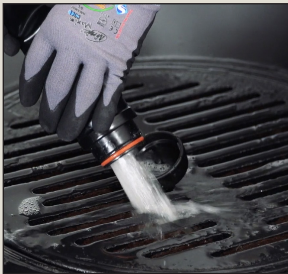
Opróżnić i umyć zbiornik na zanieczyszczenia oraz system płukawkowy
